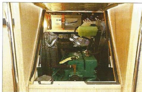
Une nouvelle fois, le moteur Volvo Penta du 455, un D 2 55 associé à un sail drive équipé d'une hélice fixe trois pales s'est révélé, côté nuisances sonores, très discret et d'une puissance largement suffisante. Seul petit bémol, la commande de gaz, située côté tribord à proximité de la console de barre, risque d'être accrochée par un cordage de manœuvre issu de la boîte à bouts.
