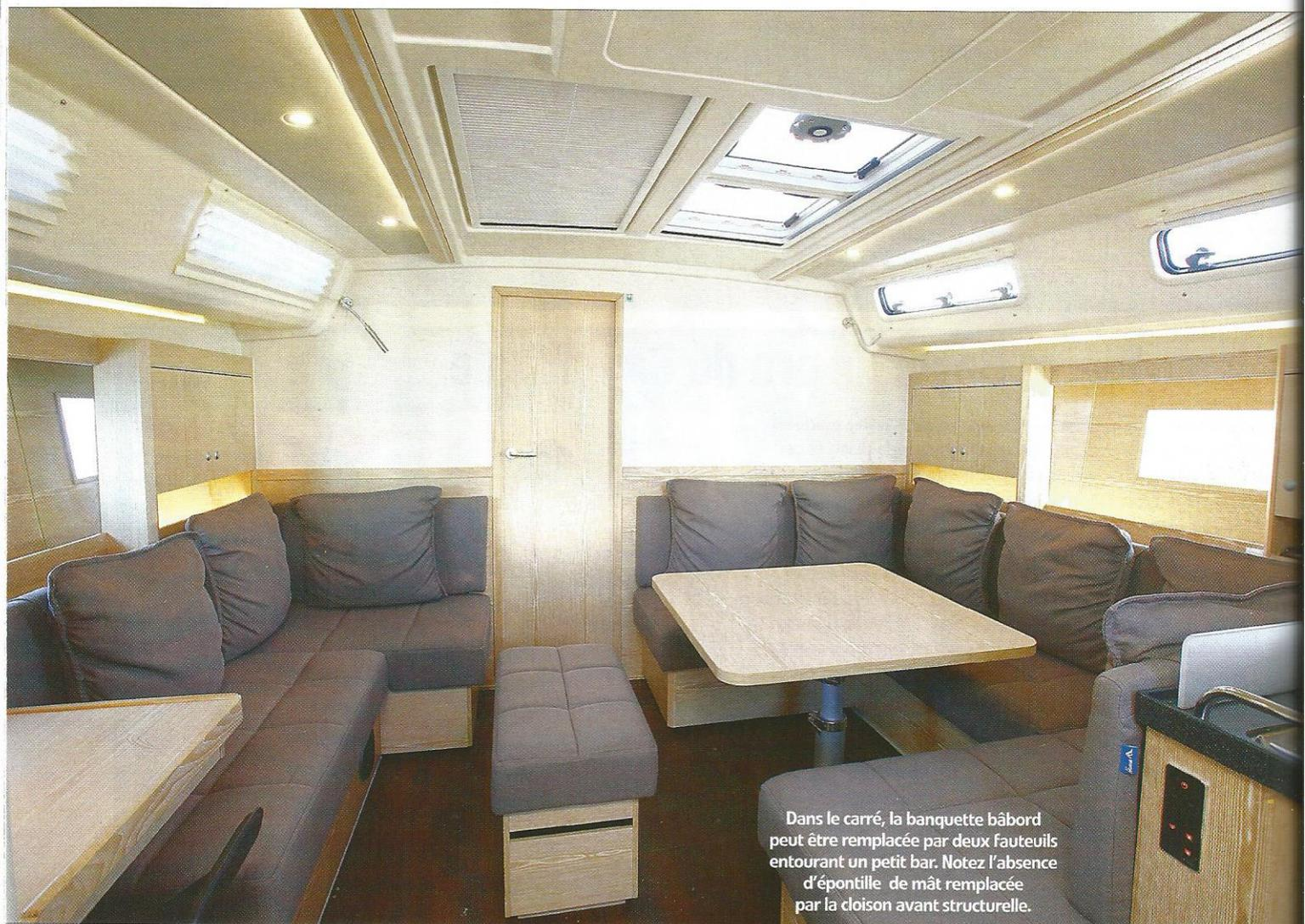
Dans le carré, la banquette bâbord peut être remplacée par deux fauteuils entourant un petit bar. Notez l'absence d'épontille de mât remplacée par la cloison avant structurelle.
