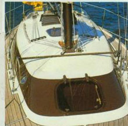
Das Teakstab-Furnier\* ist kantenfrei in das Deck eingearbeitet. Wendefock-Vorrichtung\* und ins Cockpit geführte Fallen sind nur zwei der vielen Details, die das Schiff auszeichnen.
