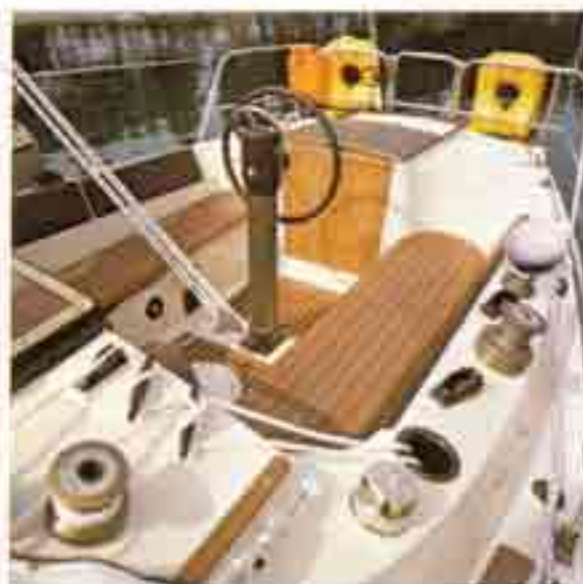
Das Cockpit der OPTIMA 98: Mit Teak-Sitzduchten und schaum- gepolsterter Sülkante.
