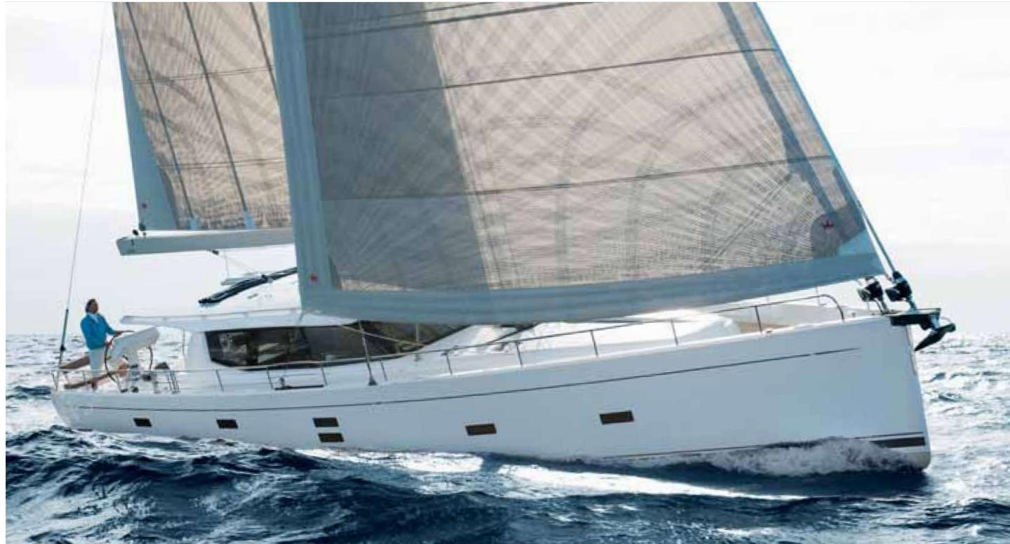
Dva přední stěhy s elektrickými rolfoky (kosatka a velká gena) zaručují plavební univerzálnost a výkon. Doplnit lze ještě genakr.
