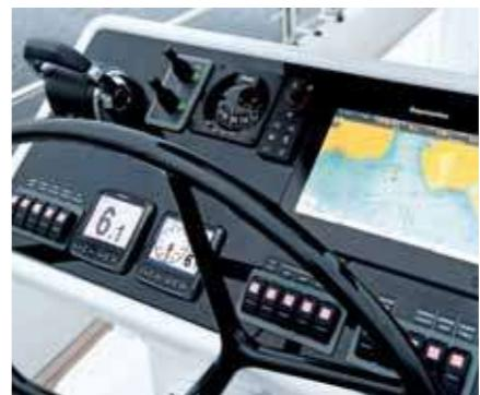
Při kormidlování je vše po ruce. Navigace, elektronika, provozní údaje, ovládání vinění, motoru i pomocných propelerů.
