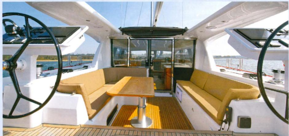
ОН СПЛАНИРОВАН АСИММЕТРИЧНО И ЧУТЬ ЗАГЛУБЛЕН. КЛАПАН МЕЖДУ ДВУМЯ БАЛКАМИ МОЖНО СВЕРНУТЬ (ЭТО ТРЕБУЕТ ЛИШЬ НЕБОЛЬШИХ УСИЛИЙ), ПОСЛЕ ЧЕГО МОЖНО НАСЛАДЬЯТЬСЯ ПЛАВАНИЕМ НА ПАРУСНОМ КАБРИОЛЕТЕ
