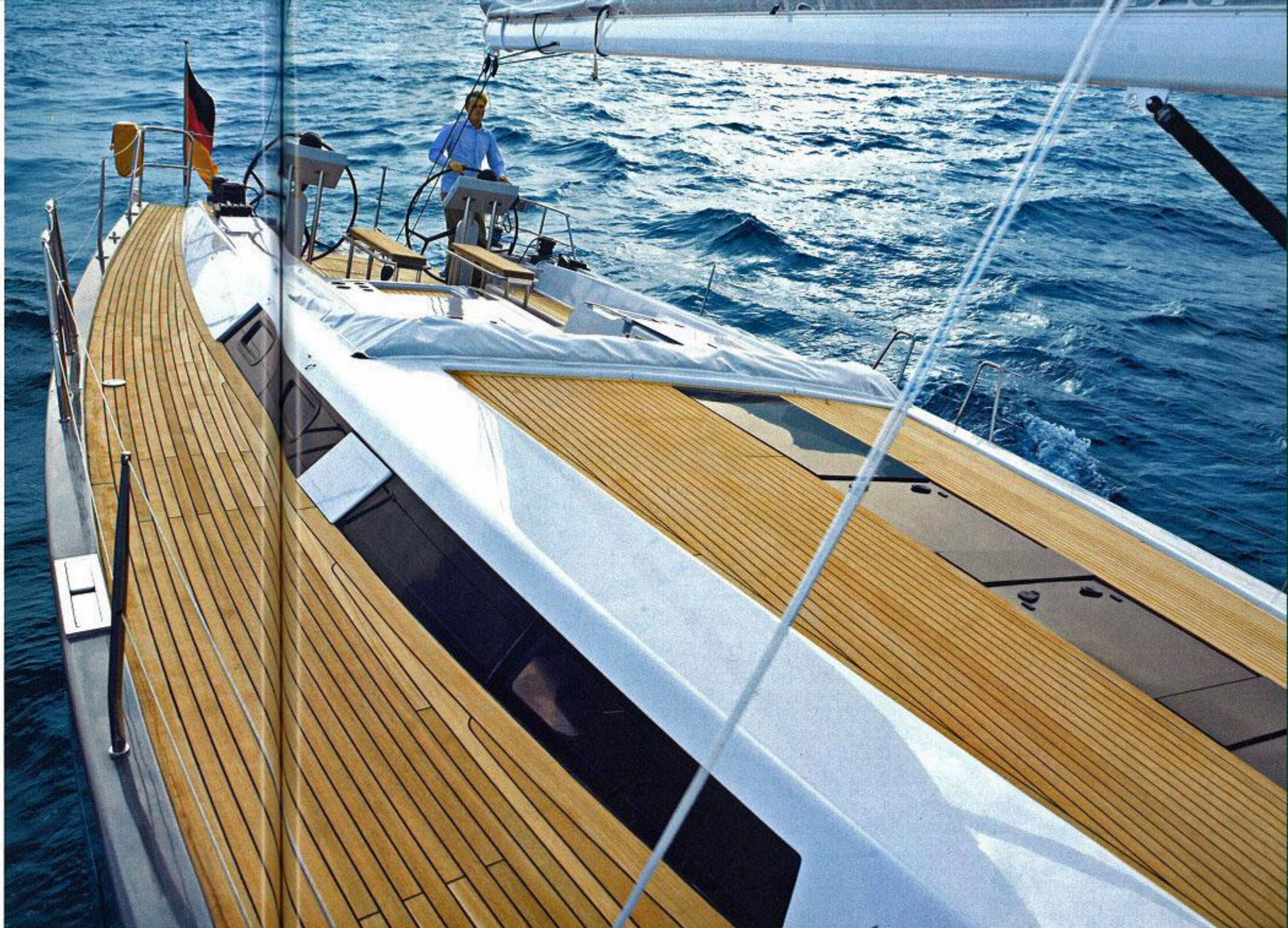
Auf der Höhe der Zeit: Unter dem Lichtband auf dem Aufbau verbergen sich drei einzelne Luks. Klampen sind versenkbar.
