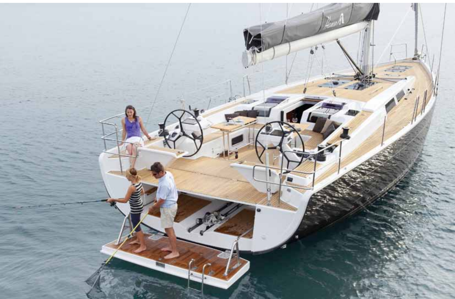
Na rufie Hanse 575 mamy hydraulicznie otwieraną platformę kąpielową. Po jej opuszczeniu ukazuje się wejście do garażu na mały ponton.
