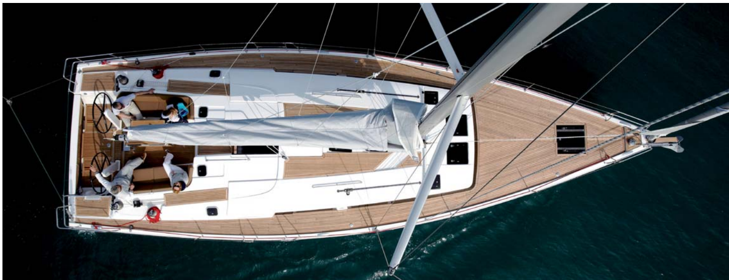
Una extensa cubierta plana, con caseta de perfil bajo que ocupa más de los dos tercios de la superficie disponible, son el reflejo del volumen interior que se ha priorizado en el diseño. Aún así se ha logrado una bañera dividida funcionalmente en zona de gobierno y de estar.
