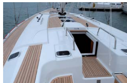
La entrada del tambucho, amplia y flanqueada por sólidos pasamanos de inox, dispone de rompeaguas, puerta de cierre vertical y acceso a través de un descansillo.
