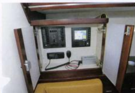
Navigaattori istuu salongin lepotuolilla ja plotteri ja sähkökeskus kätkeytyvät kaapin sisään.
