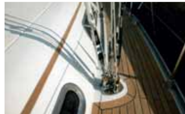
Bij een fractionele tuigage met gepijlde zalings kunnen alle krachten op het tuig op een putting worden afgeleid.
