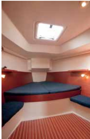
De eigenaarschut in het vooronder is strak en oogt sober. Hier is goed te zien dat de dekpanelen op een binnemaal rusten.
