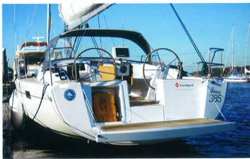
Die abgeschrägten Decksseiten der 385 machen den Rumpf optisch flacher und strecken ihn. Die Fenster öffnen nach außen und ragen ins Laufdeck. Auf Wunsch kann das Schiff mit Performance-Segeln geordert werden. Rechts unten: Die klappbare Badeplattform erweitert den Lebensraum. Unter Deck vermittelt das Schiff einen gewissen Chic
