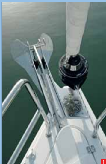
1 La proa queda resuelta por un escobén lateralizado a babor con el molinete visto en el extremo de proa.
