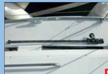
6 Los carros de escota del génova van instalados en caso de usar este tipo de vela de proa.
