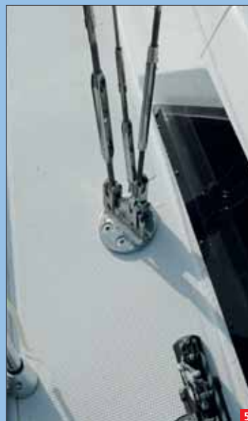
5 Los cadenotes de los obenques están cerca del roof pero dejan poco espacio para el pasillo.
