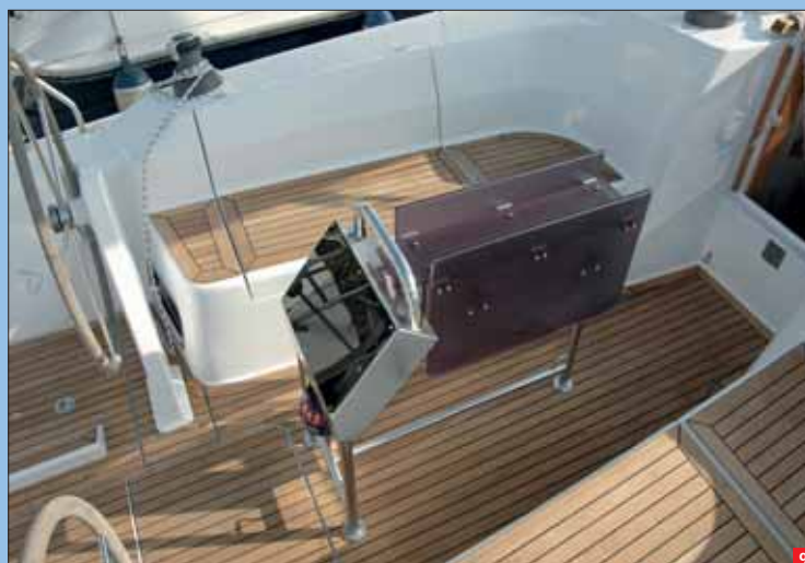
9 El soporte tubular de inox para la mesa desplegable con el que cuenta la bañera también se aprovecha como fijación para la electrónica adicional.
