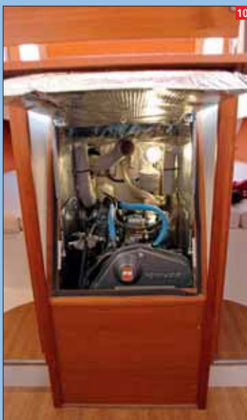
Bajo la escalera de acceso al interior alcanzaremos fácilmente el motor Yanmar.
