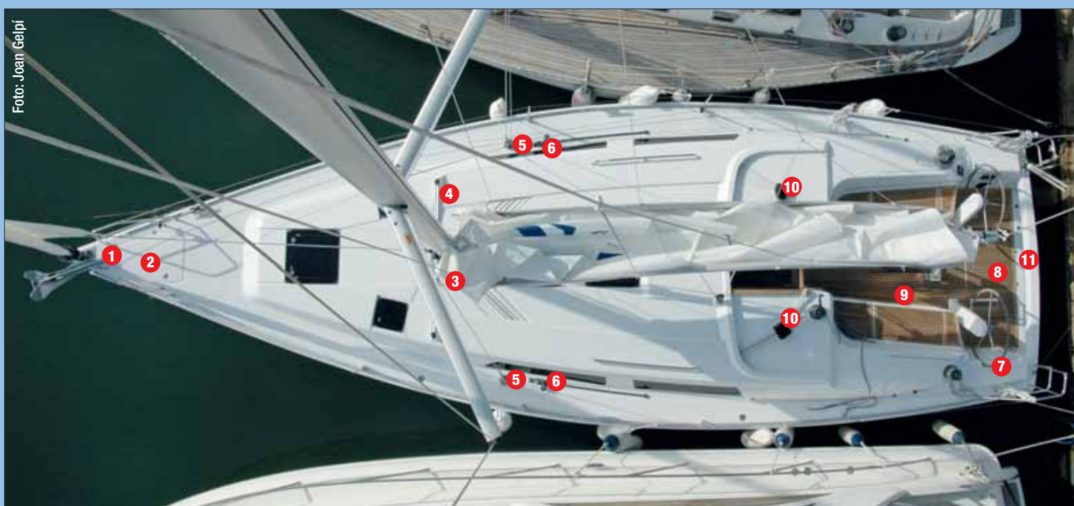
1. Enrollador; 2. Pozo anclas; 3. Pie de mástil; 4. Carro foque autovirante; 5. Cadenotes obenques; 6. Carro génova; 7. Bombona gas; 8. Cofre popa; 9. Bañera; 10. Piano; 11. Banco amovible de popa
