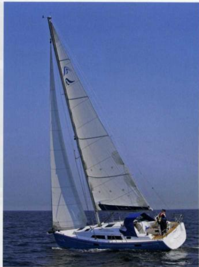
セルフタッキングシステムとはいえジブが大きく、パワフルなセールプランとなっている。オーバーラップのあるジェノアも展開可能
