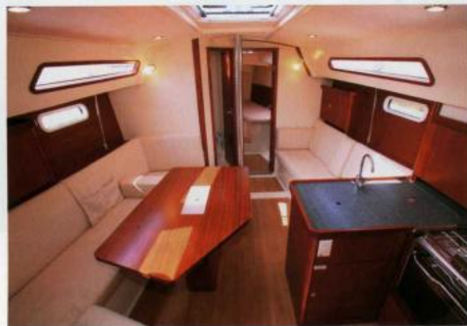
試乗艇は前部左舷側にトイレがあるので、左右のシートの位置は前後にかなりずれている。ユニークなレイアウトだ
