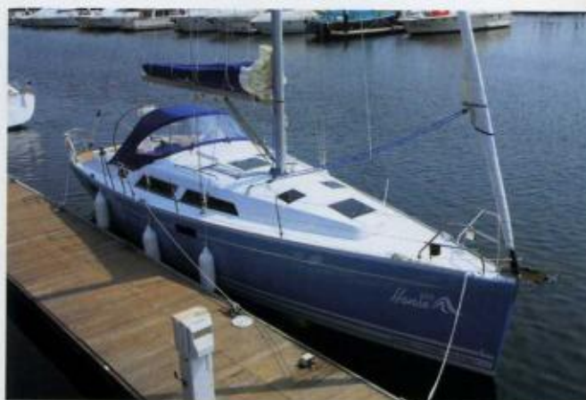
上: 左舷側にオフセットしたステム金物はジェネカー用のピンが差せるようになってい る。ハッチ類はフラットになるフラッシュタイプ 左: コクピットスペースも十分な上、シートも目いっぱい設けられている。トランサム のヘルムスマンシートの中央部分はオプション
