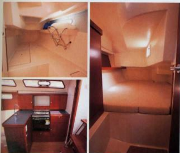
左上: 甚星として仕上げられていない感のある試乗艇の左舷アフツァビン。このタイプは現在では作られていないとのこと 左下: キャレーはL字型で、前後左右に広いスペースがある。カバーされていて見えないうがシンクも前後に二つ並んでいる 右: 右舷側のアフツァビンは、どのレイアウトタイプでも共通だ。コーミングトップ高さがキャビン内高さに貢献している
