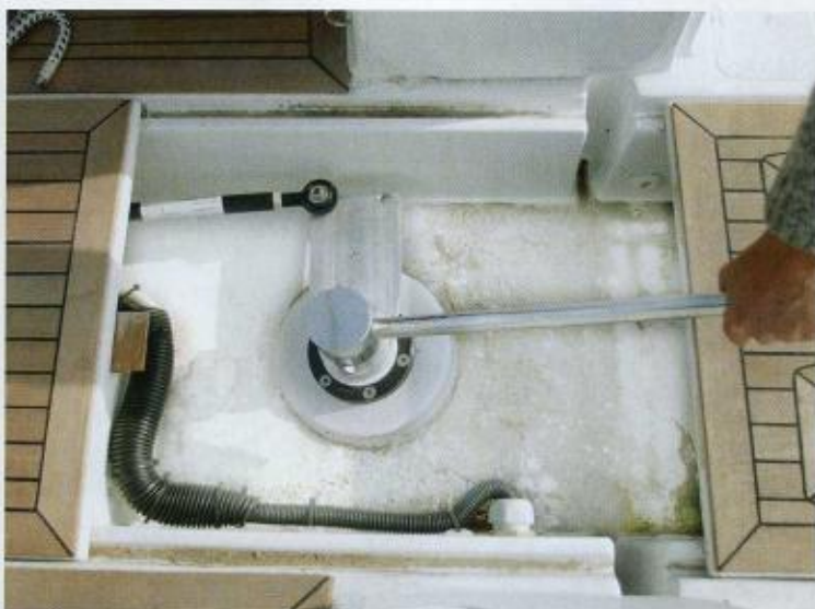
De noodhelmstok is eenvoudig te plaatsen op de roerkoning onder het inspectieluik.
