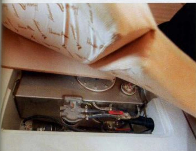
Op de dieseltank. Vanwege de extra inertie die dat oplevert, houden we daar niet van.
