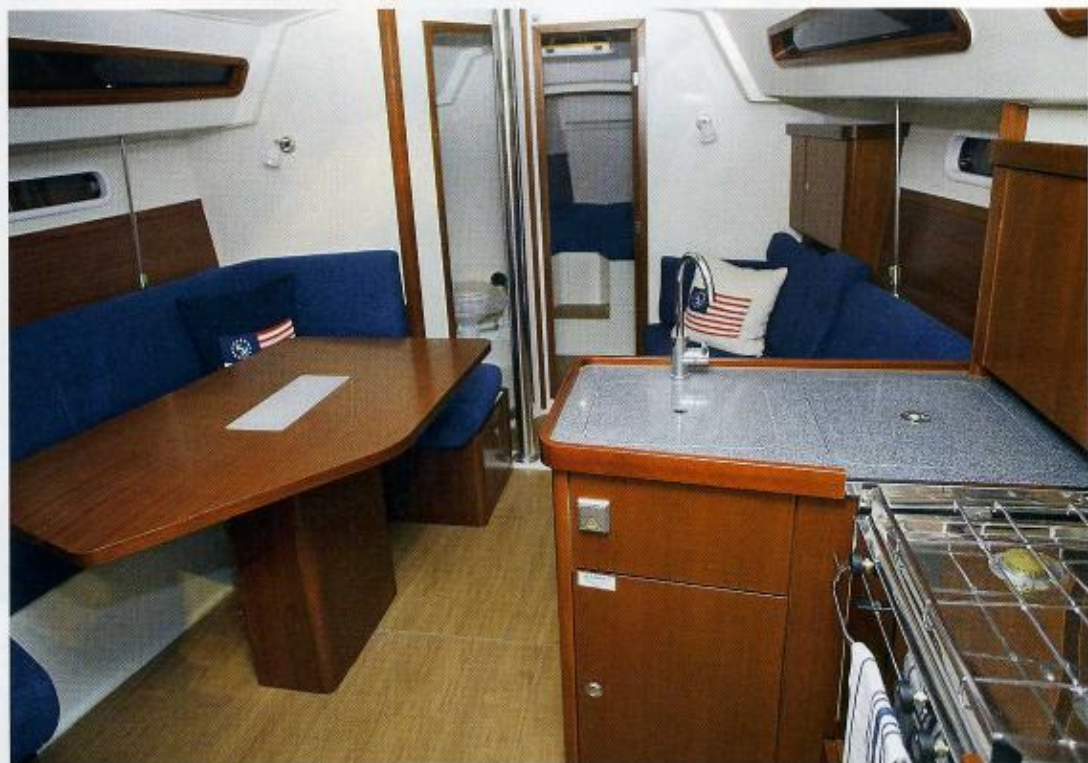
350:ans ovanliga planlösning med snedkapat salongsbord, toalett intill förpiken och förskjutna soffor och många luckor och fönster. Resultat: en ovanligt luftig och ljus salong med stort pentry.
