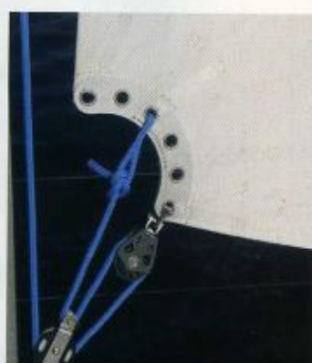
El puño de escota del foque tiene diferentes ollaos para regular el ángulo de tiro de la escota.
