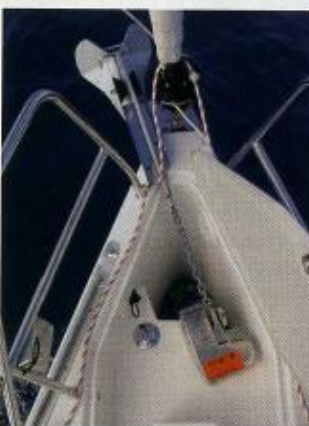
Con el estay en la roda, el es-cobén sale desviado respecto a cruja. El molinete está dentro del cofre en ambos barcos.
