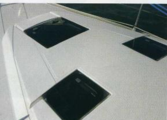
El extremo anterior de la caseta en el 350 tiene tres escotillas enrasadas con la fibra, sólo una en el 320.
