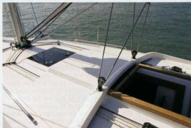
En el barco de más eslora la escota de mayor va anclada sobre la caseta; el carro de escota es opcional.
