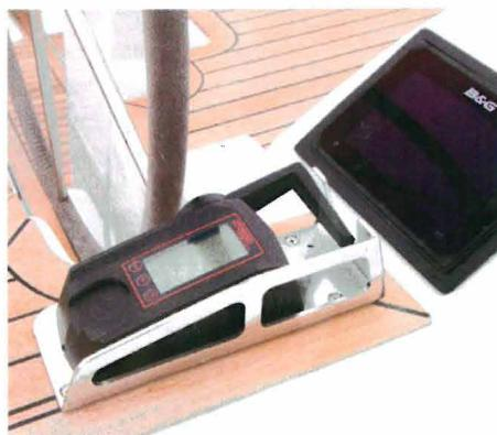
Ovládání elektromotoru Torqeedo
