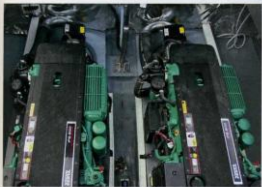
Motorisierung Fjord liefert die 40 open ausschließlich mit zwei Dieselmotoren und IPS-Antrieben. Letztere sitzen unter dem Rumpf.
