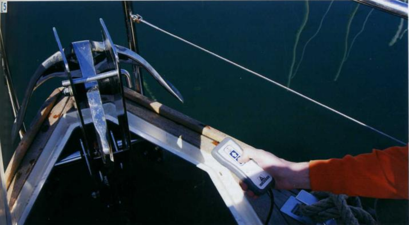
5]. Ευρύχωρο το στρίπσο της άγκυρας. Ηλεκτρικός εργάτης και αναξείδωτη δελφινιέρα συνθέτουν το χώρο της πλώρης. 6]. Το πιλοτήριο του σκάφους διαθέτει ρυθμιζόμενα και εργονομικά καθίσματα.
