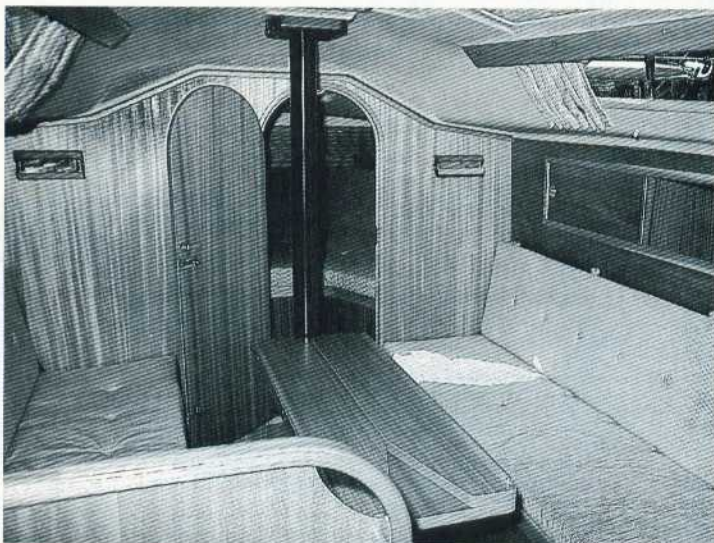
Der symmetrische Tisch läßt sich beidseitig nach oben umklappen, dadurch wird der Weg nach vorn frei gemacht.
