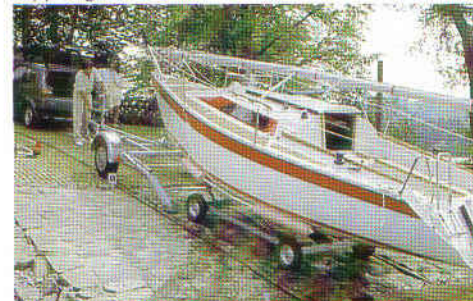
Mit der Seilwinde werden Boot und Slippwagen aus dem Wasser gezogen. Wasserballast wird durch ein Zugventil abgelassen.
