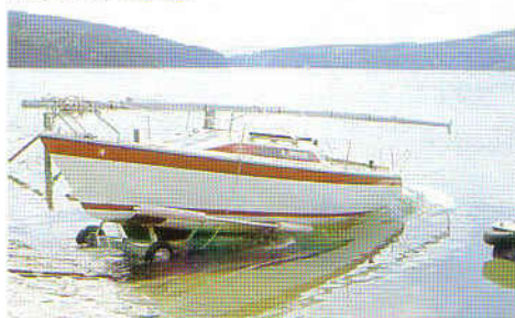
Der schwimmbare Slippwagen bringt das Boot ins Wasser. Wasserballast wird autom. aufgenommen.
