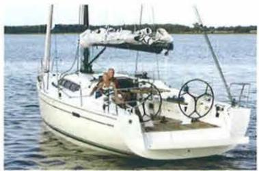
ビームいっぱい近くまで幅のある開閉式トランサムゲートを開くと、大型のスイミングプラットフォームが出現する
