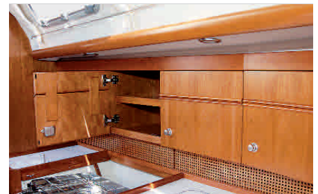
Optische Streckung: Die Schapps sind jetzt mit flachen Ventilationslamellen versehen
