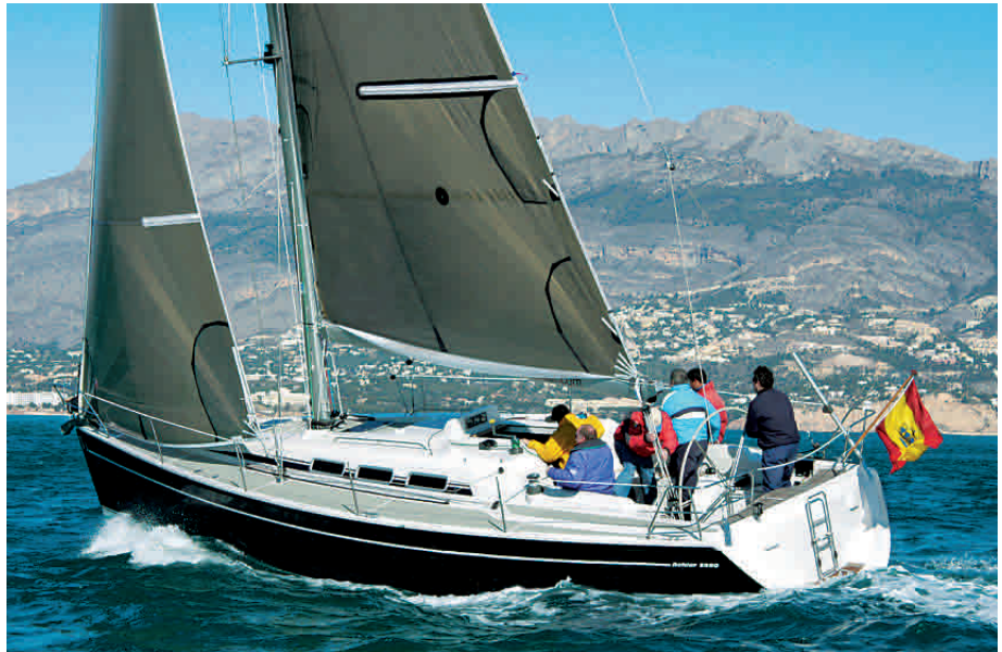
Klare Linien: Der gestreckte Rumpf und das scharfe Vorschiff weisen die SQ als Performance-Cruiser aus. Die Wasserlinie wuchs gegenüber der alten 39er um 17 Zentimeter
