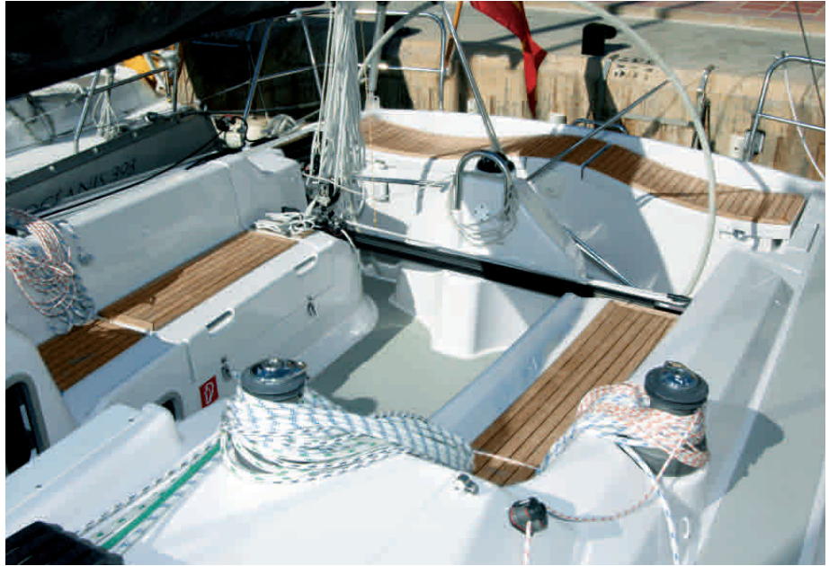
Schön gemacht: Die Steuersäule ist jetzt als ganzes Element fest mit dem Cockpitboden verbunden, das gibt Stabilität. Der Bewegungsspielraum von Crew und Skipper ist größer
