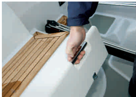
Gut durchdacht: solide Handgriffe, eingearbeitete Fußstützen am Backskistendeckel
