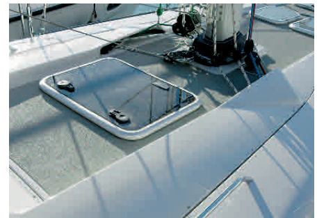
Voll verdeckt: Die Fallen und Strecker verschwinden auf dem Weg zu den Stoppern
