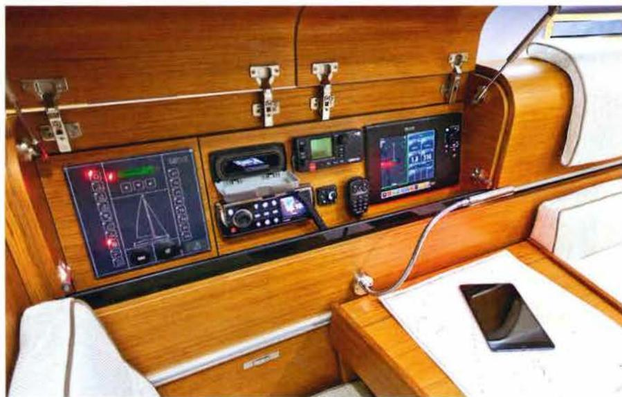
Navigační stolek je vsazen do levoboční pohovky a dá se spustit, aby se obě části pohovky propojily. Zajímavým prvkem jsou skříňky se zaoblenými víky, v nichž se ukrývají navigační přístroje.
