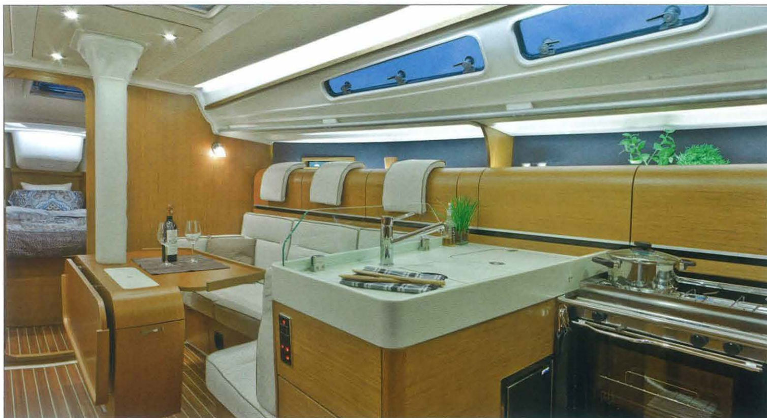
La cocina, en estribor, adopta forma de L y se abre a la distribución del salón.
