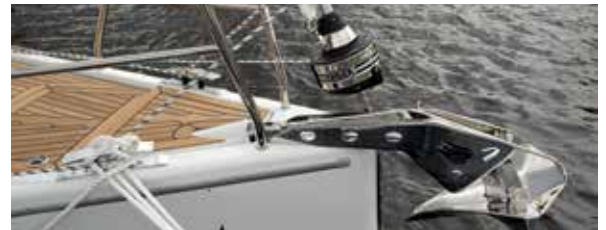
Rulleforstaget har tromle over dækket, så forstag og mast kommer længst muligt frem i båden. Det giver bedre plads i salonen. Bemærk det rustfrie anker.
