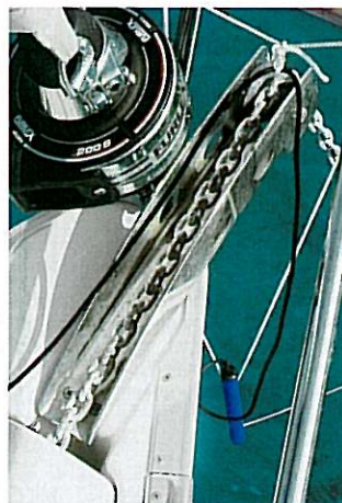
Spannt sich die Kette, melden Sensoren „Alarm“
