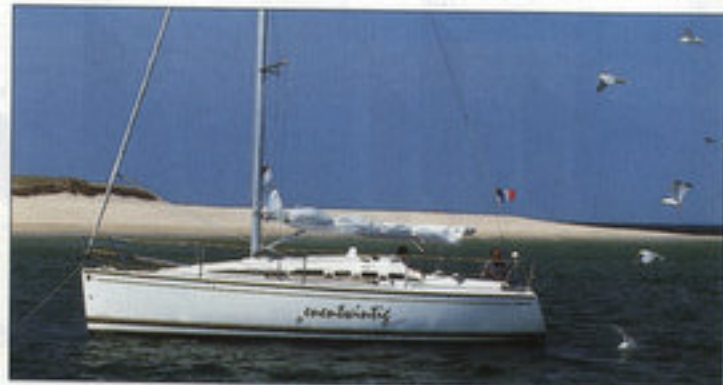
Etrave droite et grande longueur à la flottaison caractérisent le Dehler 29.
